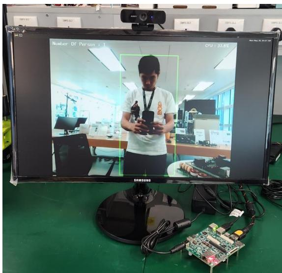
物体识别演示方案使用 einfochips EIC-i.mx93-210 和 onsemi AR0234 CMOS sensor。AI 模型在 NXP i.MX93 芯片的神经处理单元上运行，以提高准确性并优化整体 CPU 消耗。应用程序同时使用 NNStreamer 管道，允许开发人员轻松高效地采用神经网络模型，管理神经网络管道及其过滤器。
